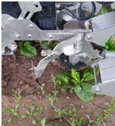
Kuva 2. FarmDroid poistaa rikat aktiivisella veitsiharalla. Kuva: SjT
