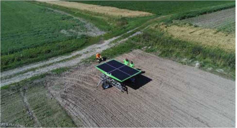
Kuva 4. FarmDroid on varustettu aurinkokennoilla ja viime kesän testeissä se toimi käytännössä ilman latausta. Pilvisemmälläkin säällä energiantarve on maltillinen, noin 1 kWh/ha.
