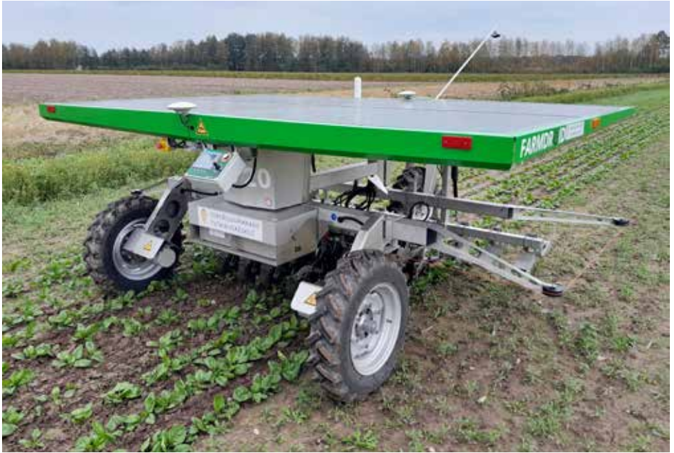
Kuva 1. Peltorobotiikalla kestäviä viljelykäytäntöjä -hankeessa testattiin 2023 tanskalaista FarmDroid FD20-robottia. Kuva: Sjt
