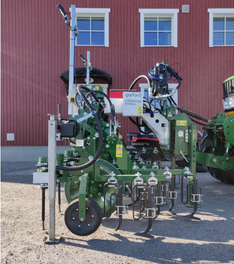
Kuva 1 ja 2. Garfordin Robocrop in-Row Weeder, jonka erityispiirteinä ovat puolikuuterät, joilla voi harata myös juurikasriviltä.
