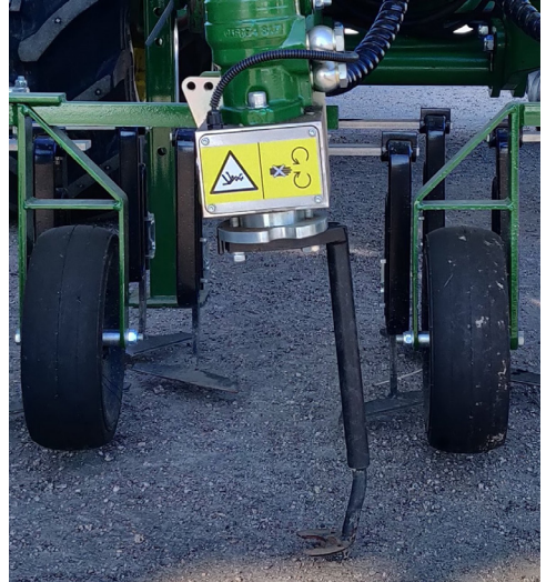
Kuva 1 ja 2. Garfordin Robocrop in-Row Weeder, jonka erityispiirteinä ovat puolikuuterät, joilla voi harata myös juurikasriviltä.
