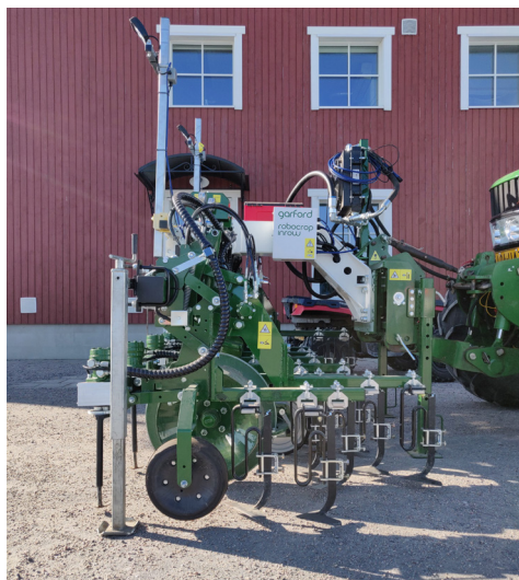
Kuva 1 ja 2. Garfordin Robocrop in-Row Weeder, jonka erityispiirteenä ovat puolikuuterät, joilla voi harata myös juurikasriviltä.
