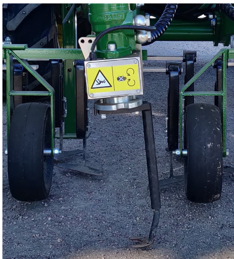
Kuva 1 ja 2. Garfordin Robocrop in-Row Weeder, jonka erityispiirteenä ovat puolikuuterät, joilla voi harata myös juurikasriviltä.
